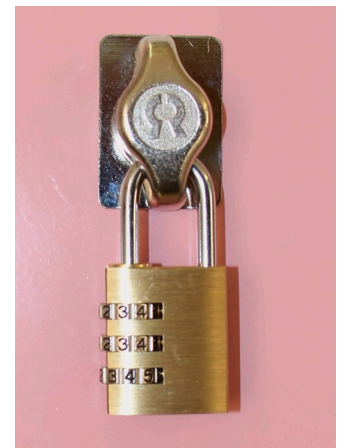
Garderobekästen mit einer Schliessvorrichtung für ein Vorhängeschloss.
